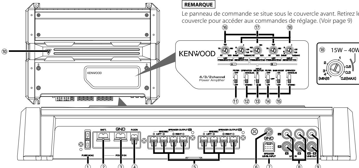
Ceci est un amplificateur à 4 canaux avec deux amplificateurs stéréophoniques en un élément; l'un appelé Amplificateur A, l'autre Amplificateur B. Cet appareil est compatible avec diverses configurations de chaîne, simplement en sélectionnant les positions des commutateurs et les fonctions comme indiqué ci-après.
