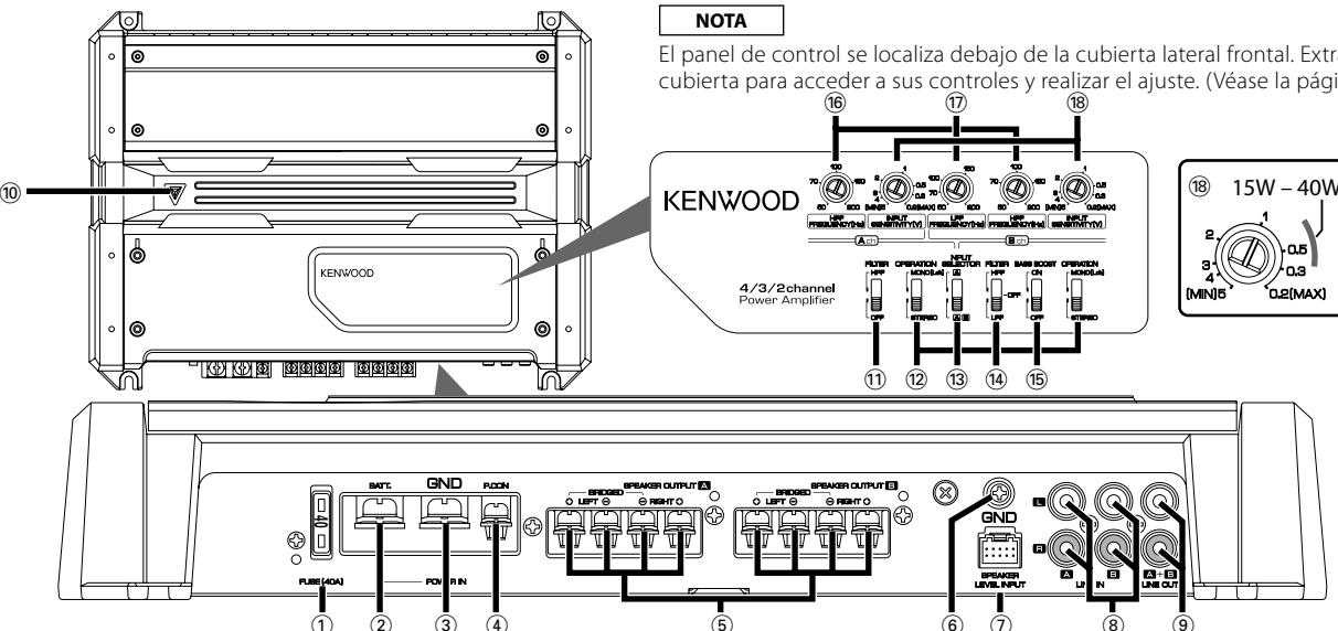
**Este es un amplificador de 4 canales con dos amplificadores estéreo en un mismo cuerpo. Uno de los amplificadores recibe el nombre amplificador A y el otro el de amplificador B. Combinando los conmutadores y las funciones descritas a continuación, esta unidad amplificadora es compatible con una amplia gama de sistemas.**
