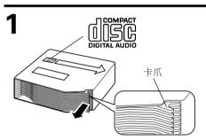
將唱片匣有"disc"標記面朝上。捏住托盤的卡爪 將唱片匣插入CD換片器中直至發出喀嗒聲。
