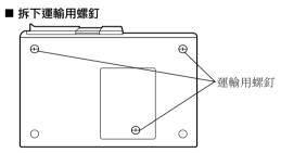
在開始安裝主機前,將為了保護內部機械而 裝有的3根運輸用螺釘全部拆下。
