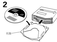
鐳射唱片在裝入托盤時標籤面要朝上。將托盤插 為防止灰塵進入換片器,CD換片器應以關好門的 入唱片匣, 直至鎖定為止。最後應確認唱片和托 狀態使用。 盤是否確實裝入。唱片號碼從底面往上表示為 「1 至6或10」。
