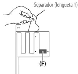
No toque la superficie adherente (lado del adhesivo) de la antena tipo película (F).
