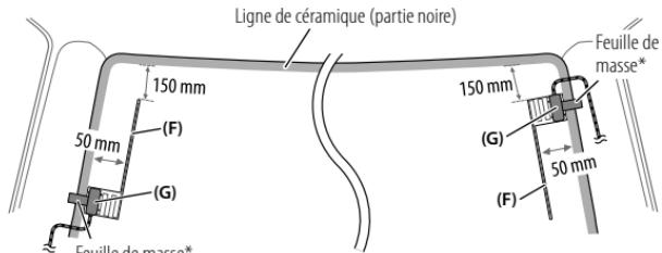
\* Collez la feuille de masse de l'amplificateur (G) sur la partie métallique du pilier avant.
