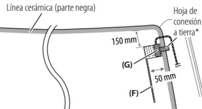
\* Pegue la hoja de conexión a tierra del amplificador (G) sobre la parte metálica del montante delantero.
