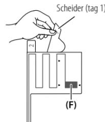
Raak het plakoppervlak (plakzijde) van de stripantenne (F) niet aan.
