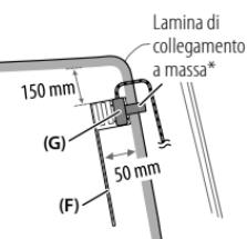
\* Incollare la lamina di collegamento a massa dell'amplificatore (G) sulla parte metallica del montante anteriore del veicolo.
