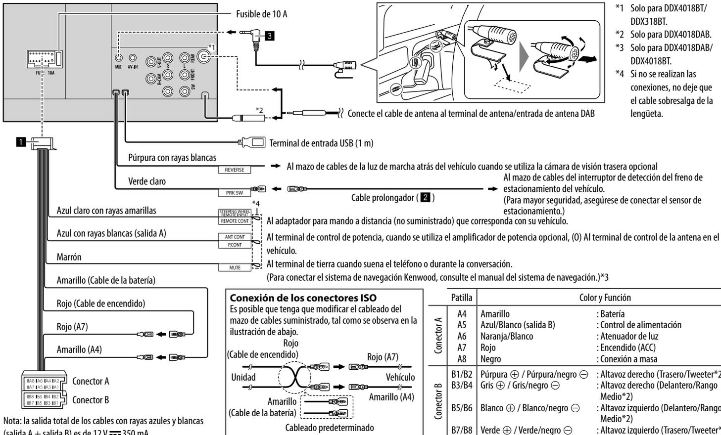
Nota: la salida total de los cables con rayas azules y blancas (salida A + salida B) es de 12 V = 350 mA.
