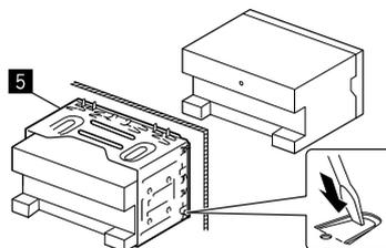
Doble las lengüetas del manguito de montaje con un destornillador o similar y fíjelo.
