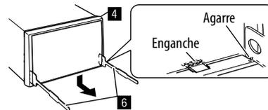
2 Libere la placa embellecedora (4) por los dos puntos de fijación superiores.
