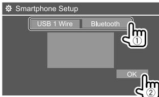
**[USB 1 Wire]** Selecciónelo cuando la unidad está conectada al terminal de entrada USB (el cable proveniente del panel posterior).
